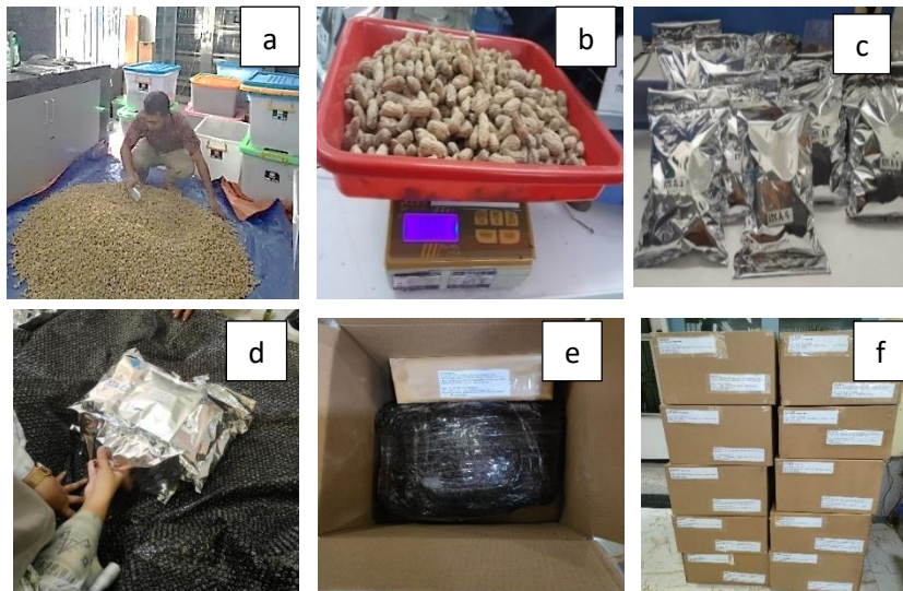
Gambar 2. a. Proses pencampuran/homogenisasi, b. penimbangan, c. pemberian kodefikasi d. Pengemasan, e. bahan uji dan juklak dimasukkan dalam kardus dan f. bahan uji siap didistribusikan.
