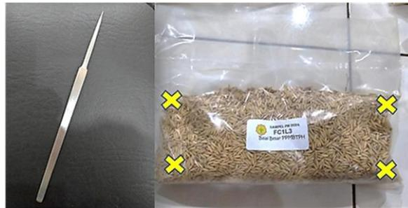
Gambar 1. Alat pelubang dan lubang pada kemasan
